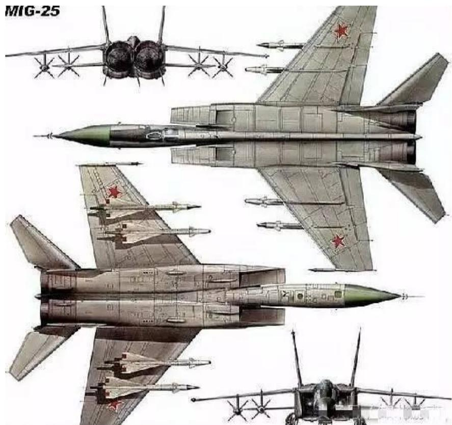
米格-25喷气式战斗机由苏联研制，它的许多零部件都没有美国制造得那么先进出色，但由于设计者考虑了整体性能，故而该战斗机在升降、速度、应急反应等方面达到了当时世界一流水准（**时速3马赫、飞行高度>25000米**）。实现了**1+1>2**。
